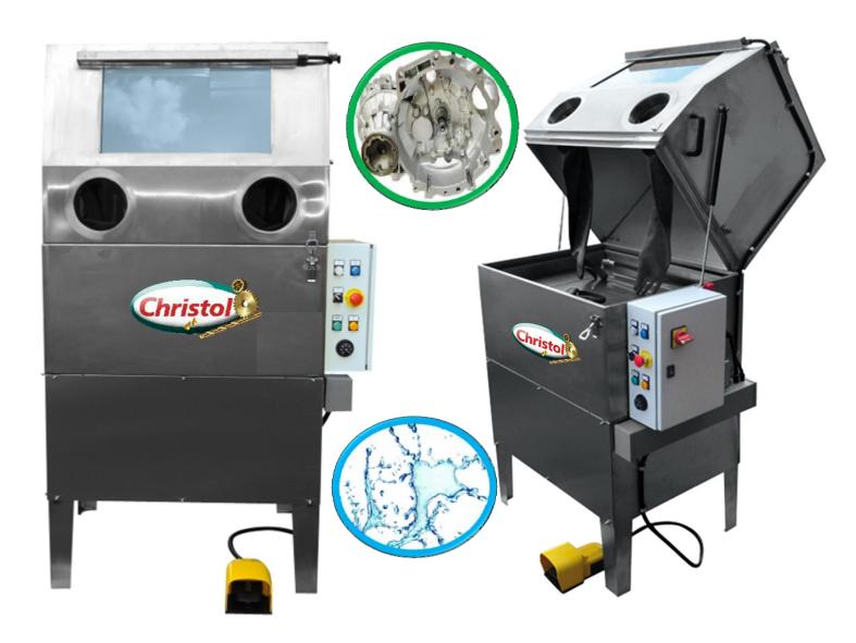
Das Wasser im Tank des Teilewaschgerätes wird nach der Erwärmung auf eine Betriebstemperatur von 20 bis max. 45°C gebracht und mit dem Reinigungsmittel befüllt. Durch die Betätigung des Sicherheitsfußschalters fließt die Reinigungsflüssigkeit durch die Hochdruckpistole und die mit öl- und fettverschmutzten Teile können abgestrahlt werden. Das Druckluftgebläse sorgt während des Reinigungsvorganges dauerhaft für eine saubere Sichtscheibe, somit ist diese frei von Spritzwasser und Schmutz.
